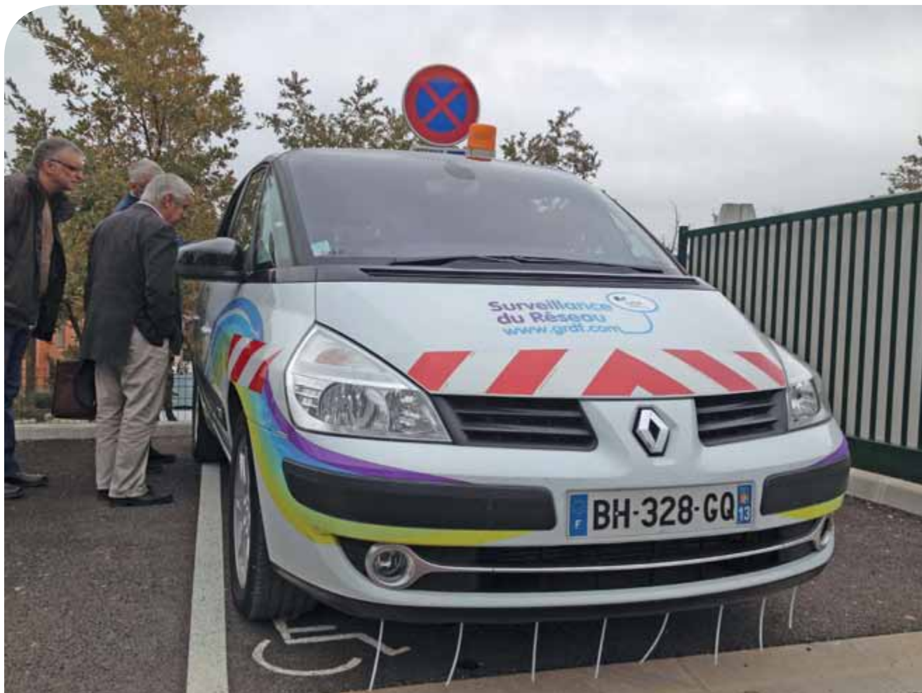
Ce véhicule renifleur de Grdf assure la surveillance des réseaux en détectant les fuites de gaz.
